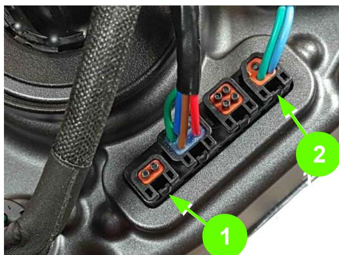
Premendo sulle linguette di sgancio scollegare il connettore del sensore di velocità (2) e il tappino della porta "Luce" (1)
