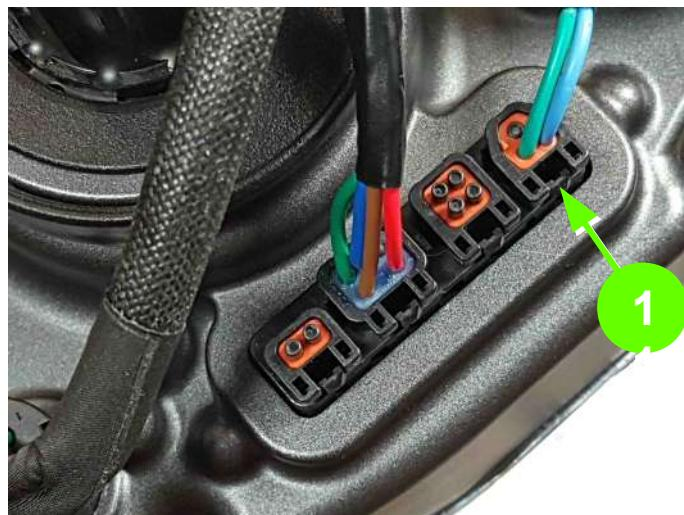
Premendo sulla linguette di sgancio scollegare il connettore del sensore di velocità (1)
